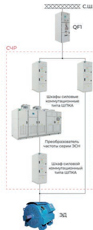
в) Однодвигательный вариант с байпасом на базе собственного оборудования
